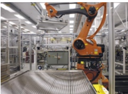
Die zylindrischen Substrate werden in Solyndras vollautomatisierter Produktionslinie von Robotern in eine Halterung befördert
